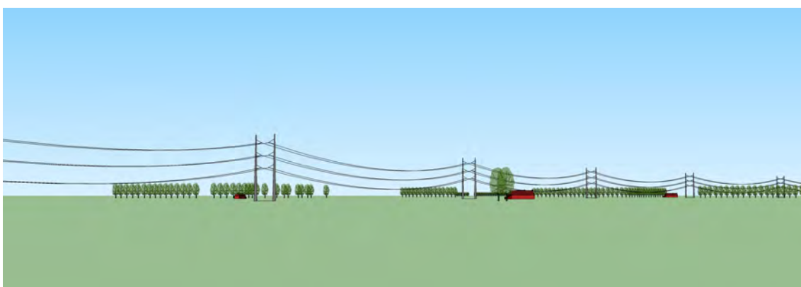
Fig. 2.5e: Principevisualisatie van een lijn met een reeks knikken van 8 graden
